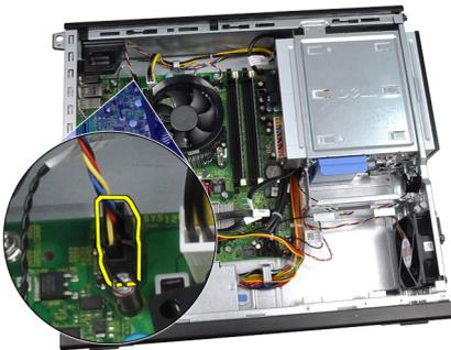
5. Saque el cable del ventilador del sistema de los ganchos del chasis.
