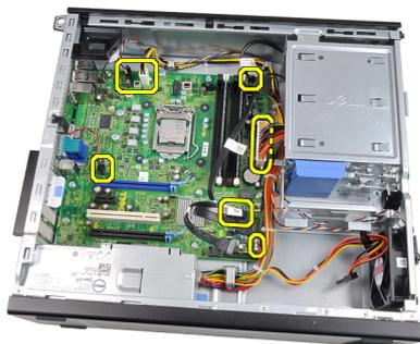
8. Levante y suelte el pestillo de la tarjeta de expansión para tener acceso a los tornillos que sujetan la placa base.
