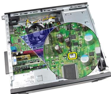
4. Saque el cable del sensor térmico del gancho del chasis.
