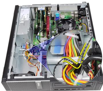
5. Levante el sensor térmico de la fuente de alimentación y sáquelo del chasis.
