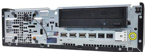
6. Deslice el panel de entrada/salida hacia la derecha del sistema para soltarlo del chasis.
