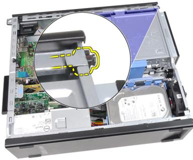
6. Saque el cable del interruptor de alimentación a través de la parte frontal del equipo.
