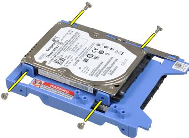
7. Doble el soporte de la unidad de disco duro y saque las dos unidades de 2,5 pulgadas del soporte.
