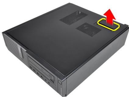
3. Levante la cubierta hacia arriba con un ángulo de 45 grados y retírela del equipo.
