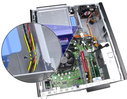
5. Presione la pestaña de seguridad del altavoz y deslice éste hacia arriba para extraerlo.
