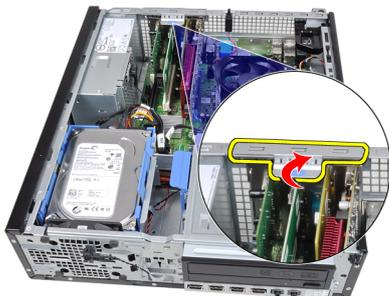
4. Tire de la palanca de liberación de la tarjeta PCIe x16 para que se suelte la pestaña de fijación de la hendidura de la tarjeta. Después deslice la tarjeta para sacarla de su conector y extraerla del equipo.
