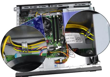
6. Deslice los cuatro aros hacia dentro y a través de las ranuras de la parte frontal del equipo.
