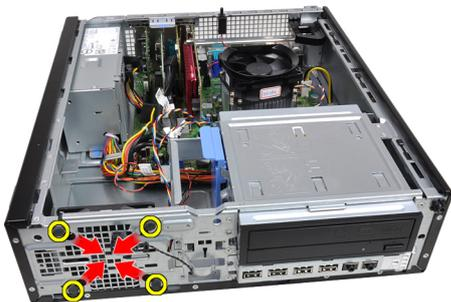
7. Levante el ventilador del sistema base y retírelo del ordenador.
