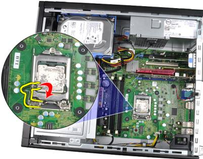
8. Levante el procesador para retirarlo del zócalo y colóquelo en un embalaje antiestático.
