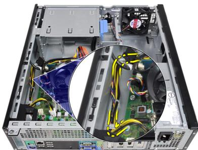
6. Desconecte el cable de alimentación de 24 patas de la placa base.
