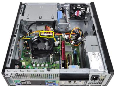
7. Saque el cable de alimentación de 24 patas del gancho del chasis.
