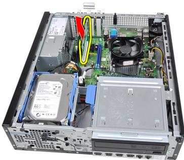
7. Deslice la tarjeta de expansión PCI x4 (si la hay) para sacarla de su conector y extraerla del equipo.
