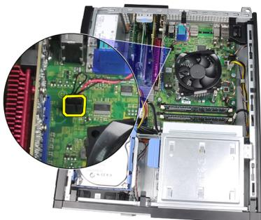
4. Deslice el interruptor de intrusiones hacia la parte inferior del chasis y extáigalo de la placa base.
