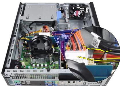
8. Retire los tornillos que fijan el suministro de energía a la parte posterior del equipo.
