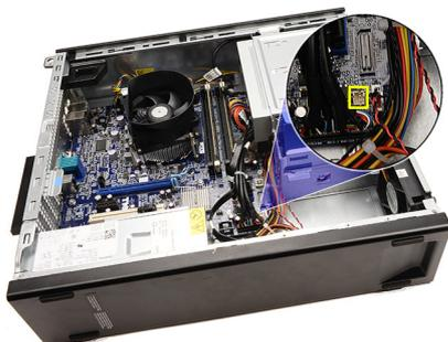
5. Saque el cable del sensor térmico de los ganchos del chasis.
