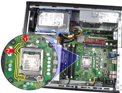
7. Coloque la cubierta del procesador.
