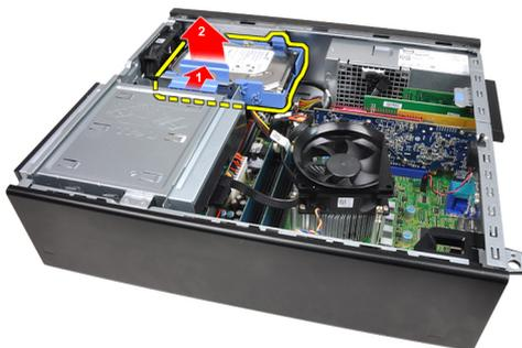
5. Doble el soporte de la unidad de disco duro y extraiga el disco duro de 3,5 pulgadas o los dos de 2,5 pulgadas del soporte.
